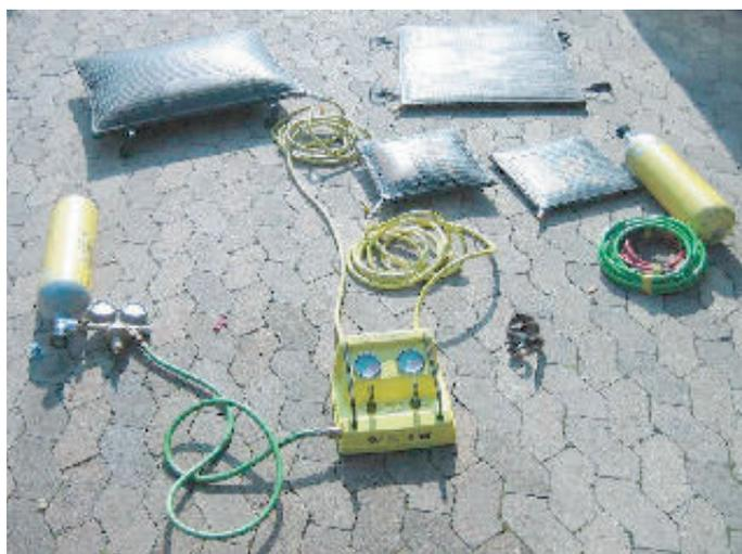
2 große und 2 kleine Hebekissen mit Steuergerät
