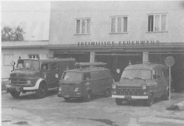
**Der Wagenpark der FF Piesting heute: Ein 2000 l-Tanklöschfahrzeug, ein VW-Rüstfahrzeug und ein Kleinlöschfahrzeug.**
